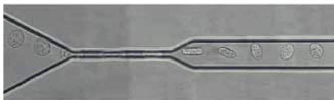
Passage de cellules dans un microcapillaire pour étudier leurs propriétés mécaniques.
